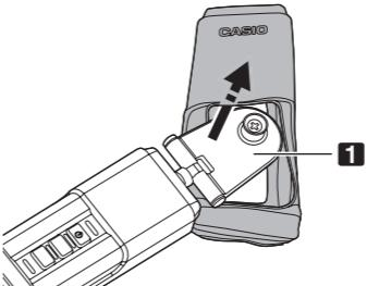
2. Tire de la pieza de fijación de correa **1** a través de la apertura de la cubierta de silicona con el logotipo de CASIO.
