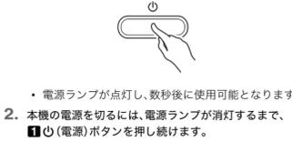
2. 本機の電源を切るには、電源ランプが消灯するまで、**1** (電源) ボタンを押し続けれます。
