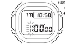
★表示が点滅しているときに **Ⓚ** ボタンを押すと、タイマー方法 (リピートタイマー / オートリピートタイマー) が選べます。
