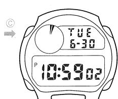
※秒(時刻・カレンダー)セット状態で表示を点滅させたままにしておくと、2~3分後自動的に点滅が止まり、時刻・カレンダーモードに戻ります。
