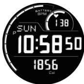
Ejemplo de pantalla (área superior de la pantalla: ritmo cardíaco, área inferior de la pantalla: Calorías quemadas)
