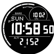
Ejemplo de pantalla (área superior de la pantalla: presión barométrica, área inferior de la pantalla: altitud)
