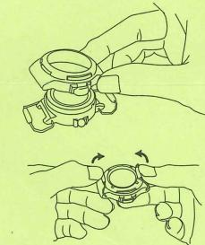
(3) 時計本体とリングとベゼルが隙間なくついていることを確認してから、図のようにプロテクターを閉じます。
