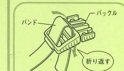
(2) 下図 ① ~ ③ のようにバックルにバンドを通し、固定させます。
