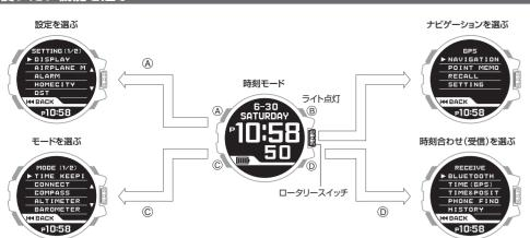
時刻モードから 🕲 🔘 ボタンまたはロータリースイッチを押した後、ロータリースイッチを回して、目的の機能を選びます。 さらに、ロータリースイッチを押して、操作を開始してください。
