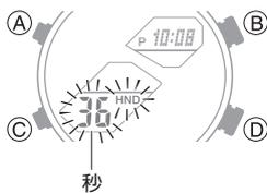
4. B ボタンを 7 秒以上押し続け、[ALL] と [RESET] の交互表示から [RESET] のみの点灯に変わったら指を離します。
