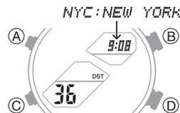
3. サマータイムの設定を変更する場合は、A ボタンを 2 秒以上押し続け、現在のサマータイム設定が点滅したら指を離します。
