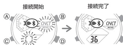
3. 画面に従って操作して、針の位置を補正します。
