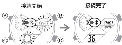
3. 画面に従って操作して、ワールドタイムを時計に反映させます。
