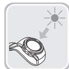
腕につけているときは、文字板(ソーラーパネル)に衣類の袖がかからないように心がけてください。文字板(ソーラーパネル)が一部でも隠れていると発電効率が低下します。
