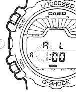
(3)「時」のセットが終わったら、⑩ボタンを押すと「分」が点滅します。「分」も「時」と同様な操作で合わせたい「分」を表示させます。
