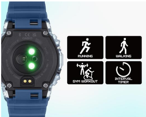
Der Gehäuseboden mit dem optischen Sensor, der die Herzfrequenz misst.
