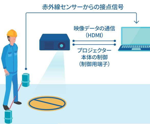
センサー検知範囲に運搬車や作業者が近づくと、スタンバイしているプロジェクターへホストコンピューターから指定した映像を任意の時間、投映するよう制御します。
